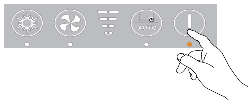
Fig. 4: Detener la alarma de filtros
